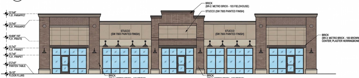
1 EAST ELEVATION SCALE: 1/8" = 1'-0"
